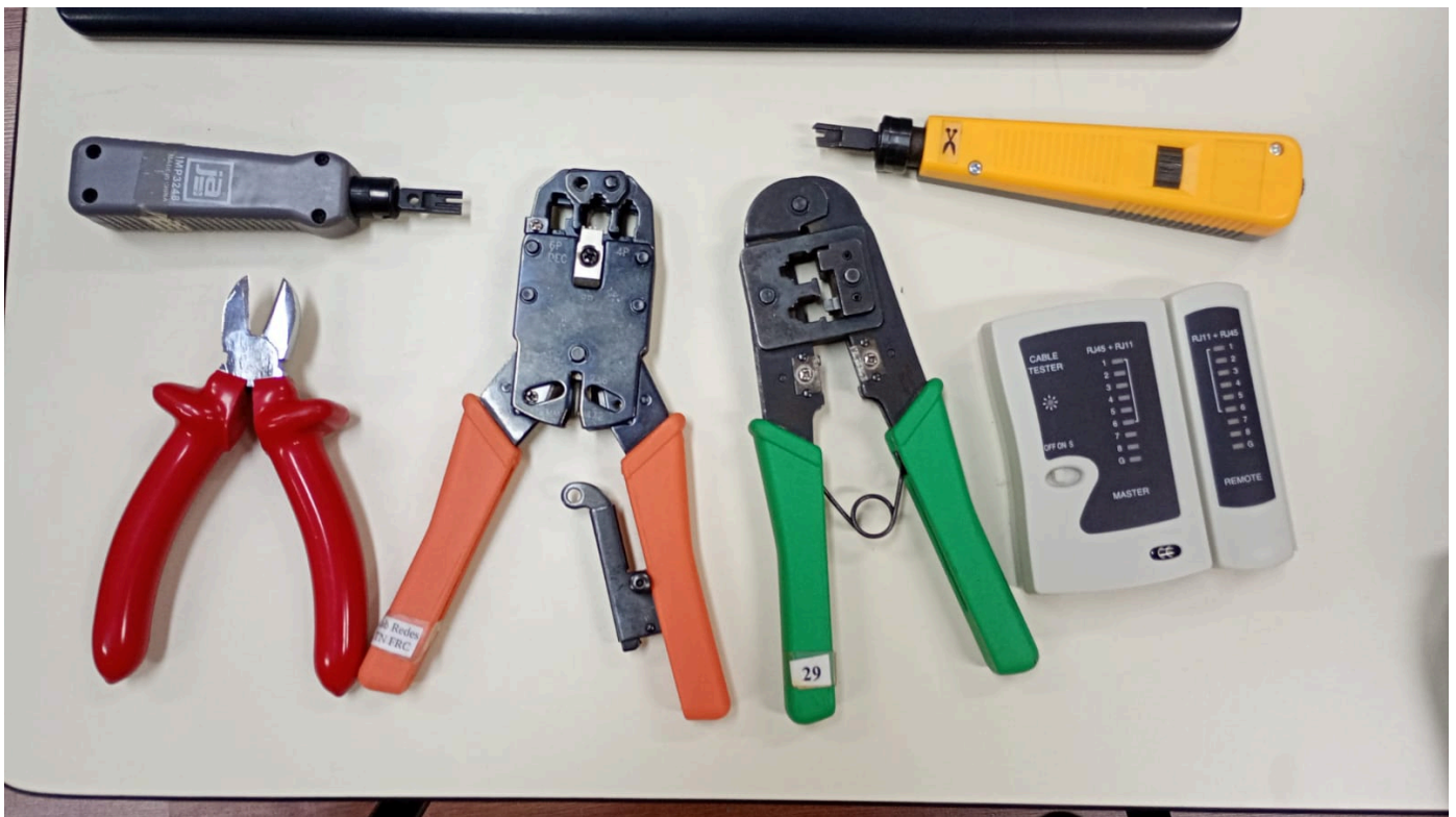
Herramientas para el armado de cables UTP
